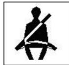
3. После пристегивания ремня безопасности сигнальная лампа гаснет, а устройство звукового сигнала перестает издавать сигнал.
