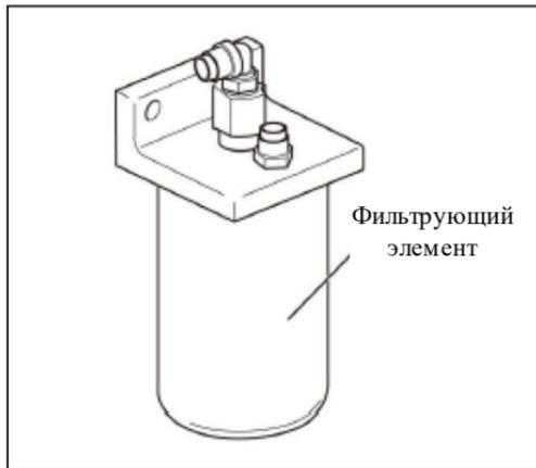
Воздушный фильтр (влаго-масло отделитель) расположен в магистрали подачи воздуха блока дозирования. Он защищает блок дозирования от воздействия частиц влаги и моторного масла, содержащихся в сжатом воздухе.
