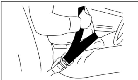
Для пристёгивания ремнём медленно (без рывков) потяните ленту ремня за язычок, чтобы её длина по груди и бёдрам была примерно одинаковой, и вставьте его в соответствующий данному сиденью замок до характерного щелчка.
